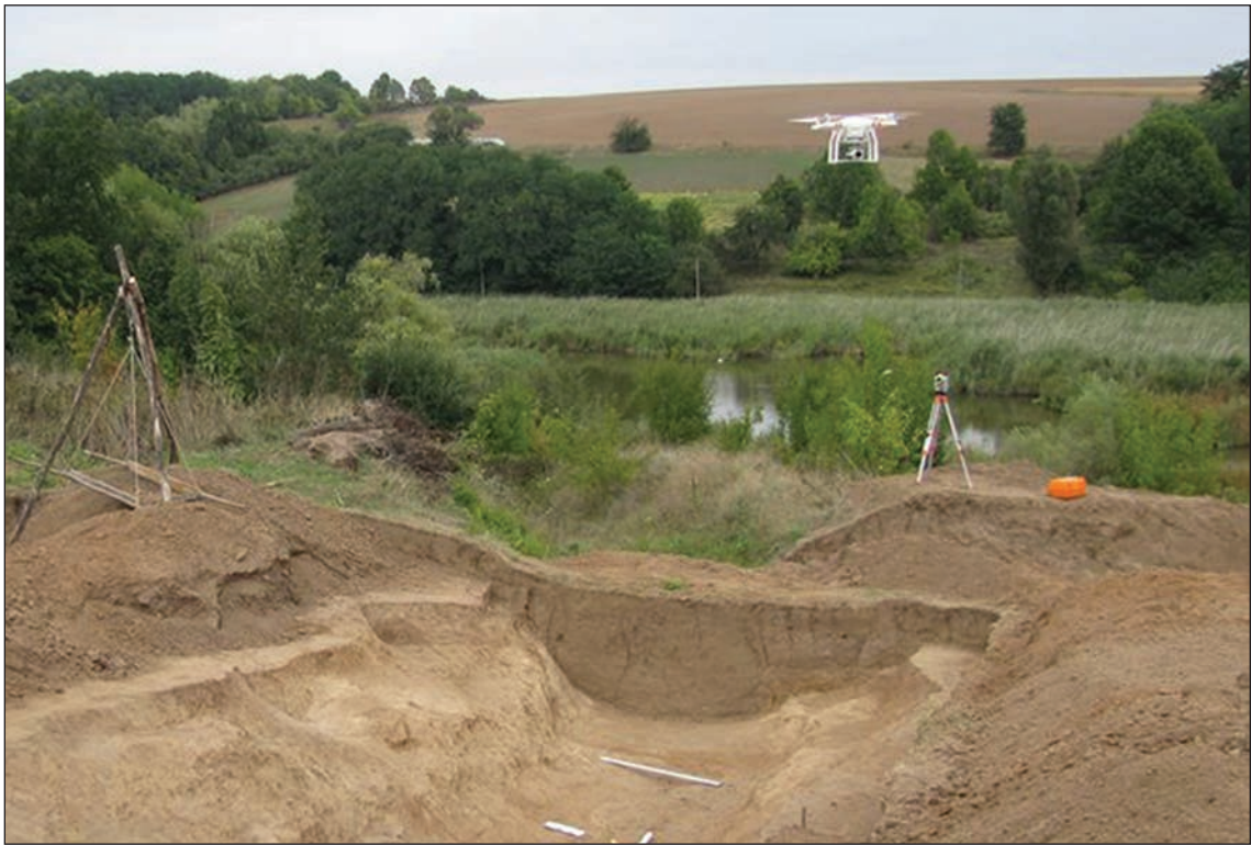
Рис. 1. Техніка аерофотограмметричного дослідження
